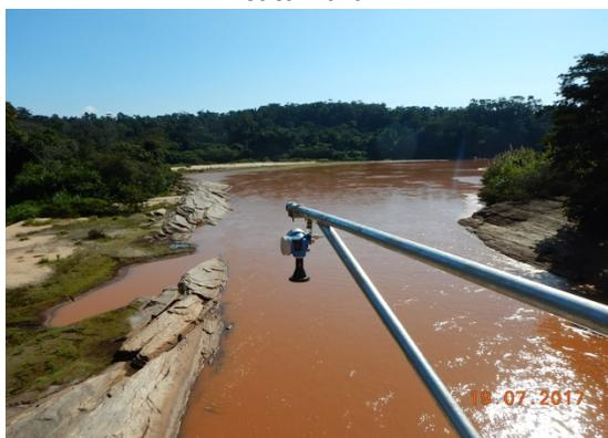
**Figura 4:** Registro de sensor de nível por radar.
